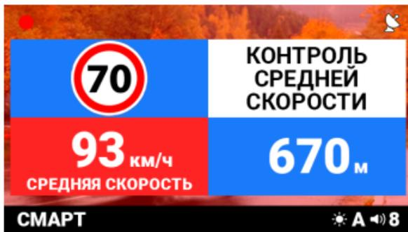
Если перед камерой, измеряющей скорость, (Кордон, Одиссей, Робот, Кречет, Места и т.д.) **текущая скорость** превысит максимальную разрешенную скорость на участке. Дисплей покажет:
